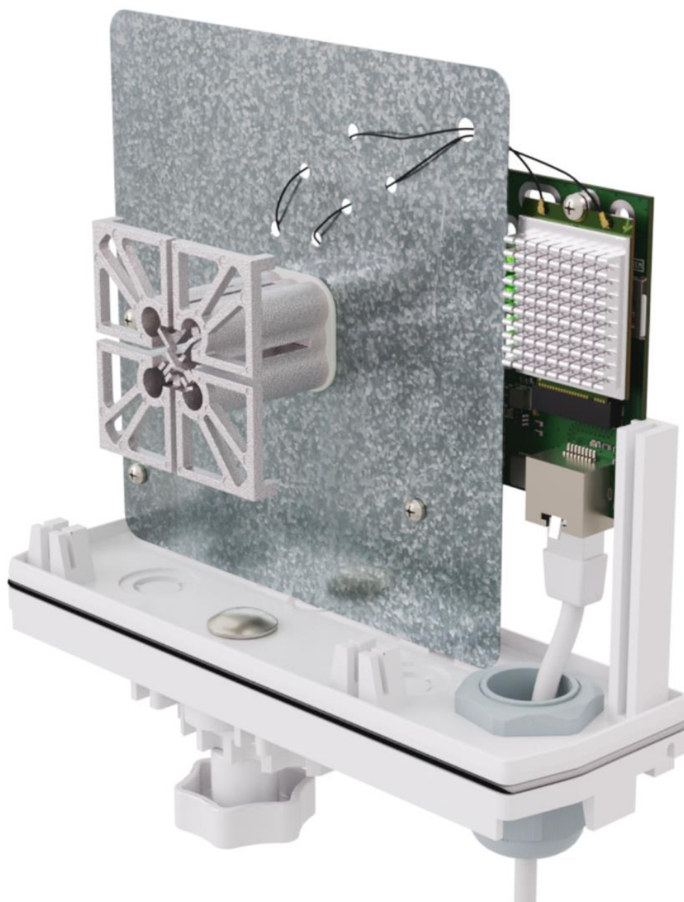
Рис.5 Установка адаптера в антенну VT-BOOST-9 MIMO 2x2.
