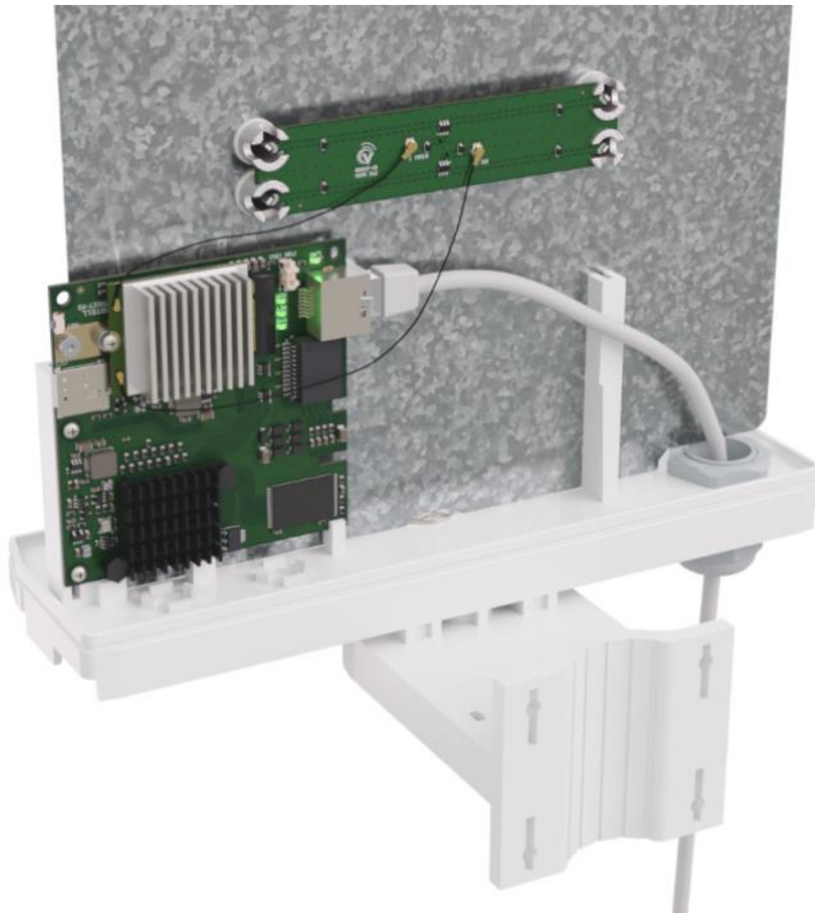
Рис.4 Пример использование встраиваемого роутера в антенне VT-BOOST-15 MIMO 2x2.
