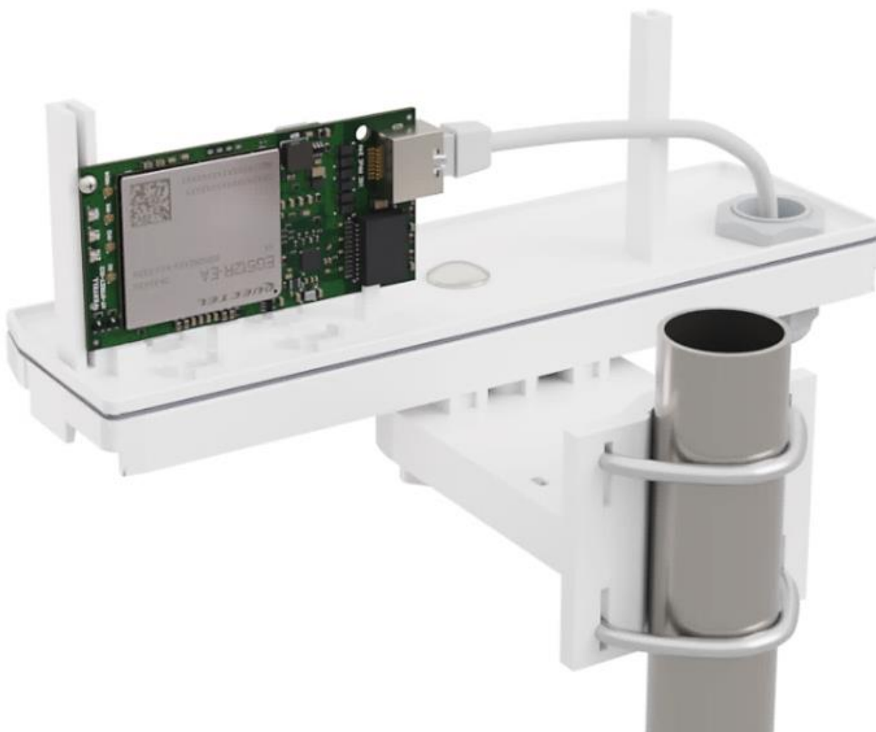
Рис.3 Пример использования встраиваемого роутера в гермобоксе VT-BOX15.
